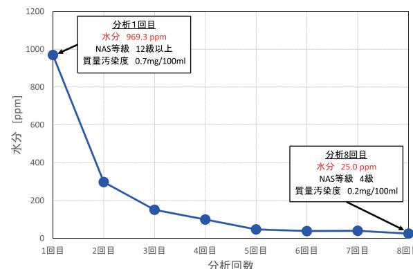
※コンタミ除去用フィルターエレメントは、水の混入によりろ過性能が低下することがあります。
